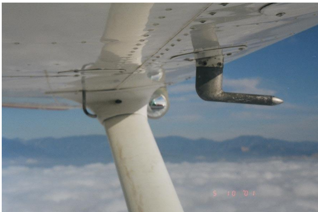
טיסה מעל העננים. מבט אל צינור הפיטון, מעט אחריו, המראה הקטנה שמאפשרת מבט אל גלגל האף המתקפל.
