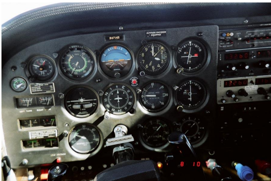
מחווני הטיסה במטוס בו טסנו. צולם בגובה '13000', למעלה משמאל לימין (מחווניים גדולים): מד מהירות – מד אופק מלאכותי – מד גובה. למטה משמאל לימין: מד שיעור פניה והחלקה, מצפן ג'ירו, מד שיעור נסיקה.
