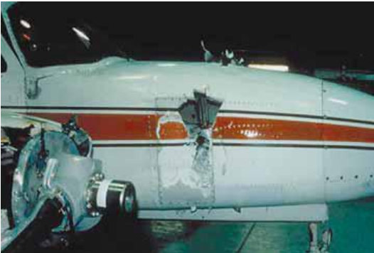
כישלון טבור קטסטרופלי שגרם להינתקות להבים וחזרים
