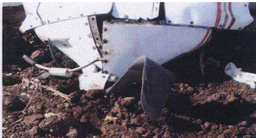
פרופלור מנוע שמאל – סימנים מובהקים של פגיעה בקרקע בעוצמה
