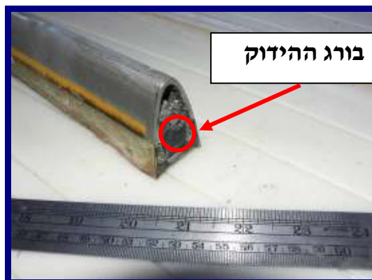
כיסוי קצה הלהב (TIP) ניתק ממקומו מבלי שתלש את בורג ההידוק
