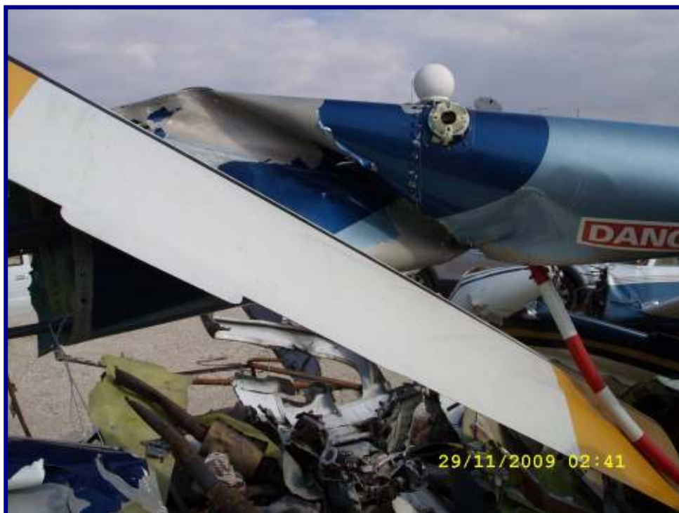
השחזור הסופי של אופן הפגיעה (בהבדל – הקורה פגעה עם חלקה התחתון)
