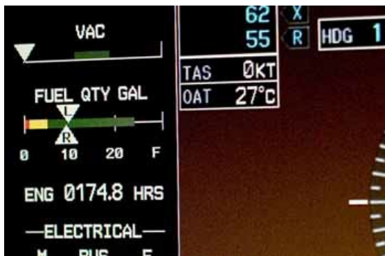
במטוס בעל תצוגות זכוכית (glass panel), כמות דלק יכולה להיות מוצגת על צג רב תכליתי (MFD).
