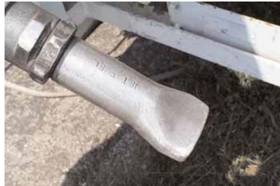
אקדח תדלוק דלק סילוני מעוצב כמקור ברוז והוא לא יתאים לפתחי תדלוק תקינים של דלק תעופתי (Avgas).
